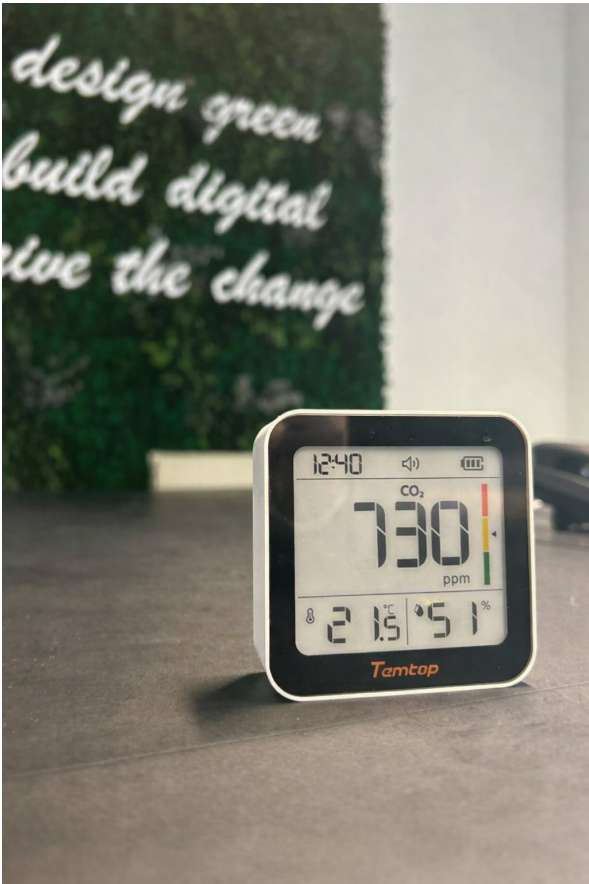
Figura 3.5 – Dispositivo di monitoraggio IAQ installato negli ambienti comuni.
